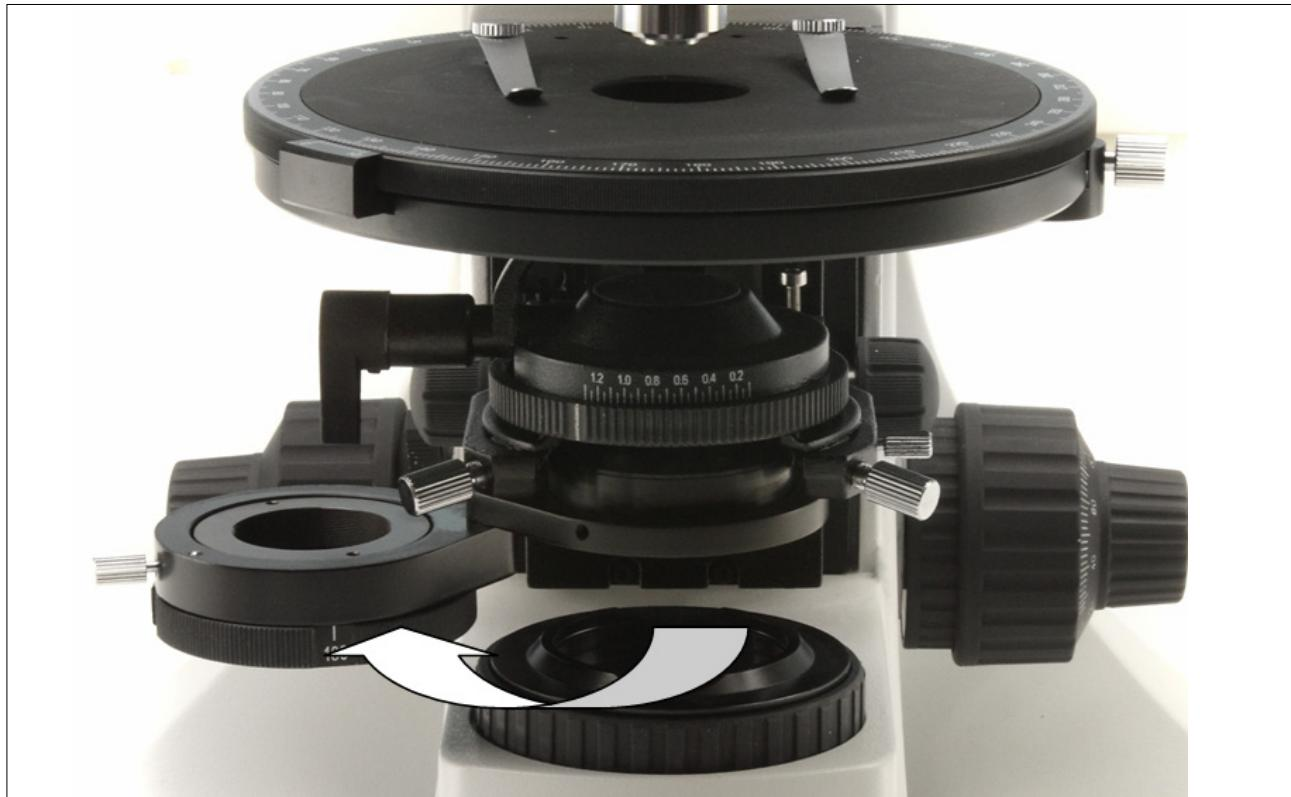
Il filtro analizzatore può essere inserito mediante la slitta sul lato destro della Lente di Bertrand. L'analizzatore ha una manopola ruotabile con incisa la scala di Vernier. Per la posizione “prismi di Nicol incrociati” tenere la scala in posizione “0”.
