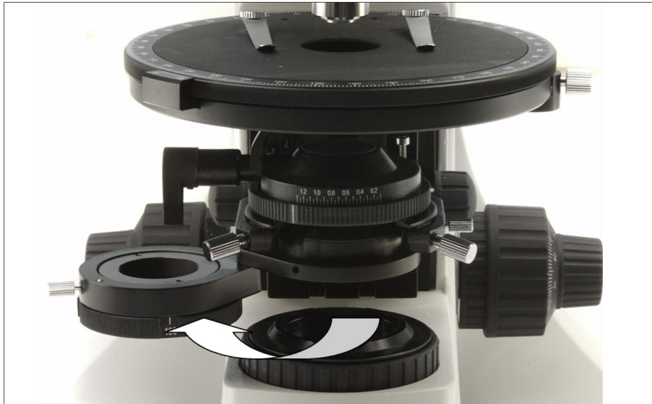
El filtro del analizador se puede insertar a través de la barra a la derecha del accesorio de la lente Bertrand. El analizador es giratorio con escala nonios grabado. Para cruzar la lente “Nicol” poner la escala en posición “0”.
