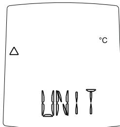
**UNIT:** aktive Temperatureinheit, umschaltbar von °C auf °F
