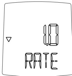
**RATE:** Messtakt in Sekunden, einstellbar von 1 Sekunde bis 15 Sekunden. Der angezeigte Wert entspricht dem eingestellten Mess-takt in Sekunden.
