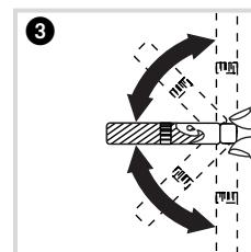
Küvette verschließen und schwenken.
