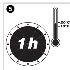
Küvette entnehmen und bei Raumtemperatur **60 min** stehen lassen.
