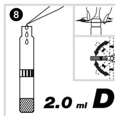
**2.0 ml** Lösung **D** (LCK 365 D) pipettieren.
