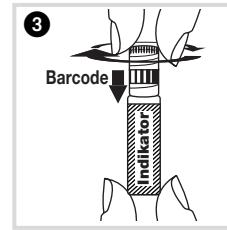
Indikatorküvette mit Membran-Doppeldeckel **sehr fest** verschließen. (**Achtung:** Barcode-Etikett muss zur Indikatorküvette zeigen.)
