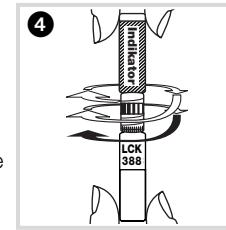
**Anschießen sofort** die Aufschlussküvette mit der vorbereiteten Indikatorküvette **fest** verschließen. Küvettenkombination senkrecht halten und **nicht** schwenken.
