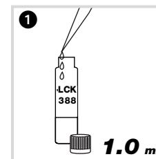
**1.0 ml** Probe in die Aufschlussküvette pipettieren.
