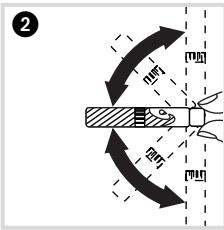
Küvette mit Originaldeckel verschließen und mehrmals schwenken.
