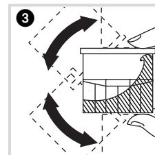
Küvette verschließen und schwenken, bis Lyophilisat des MicroCaps® gelöst ist.
