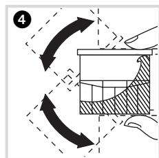
Küvette verschließen und schwenken, bis das Reagenz vollständig gelöst ist.
